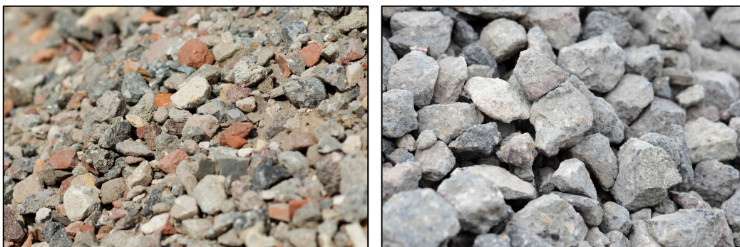
Figuur: Weergave twee typen granulaat: Menggranulaat (links) – Betongranulaat (midden)
